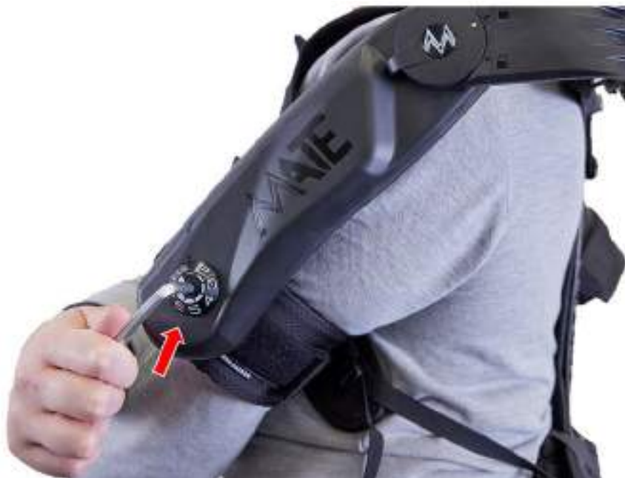
Fig. 4.3 - Vista ravvicinata della sede di regolazione posta sulla Torque Generating Box ed indicatore del livello di assistenza
