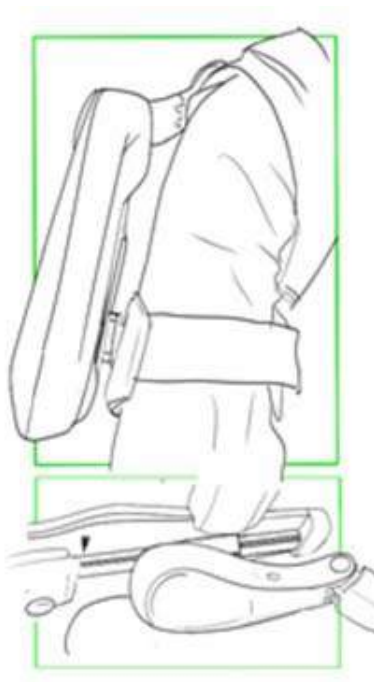
Fig. 6.1 - Dettaglio sulle slitte della Torque Generating Box e dei pDOFs
