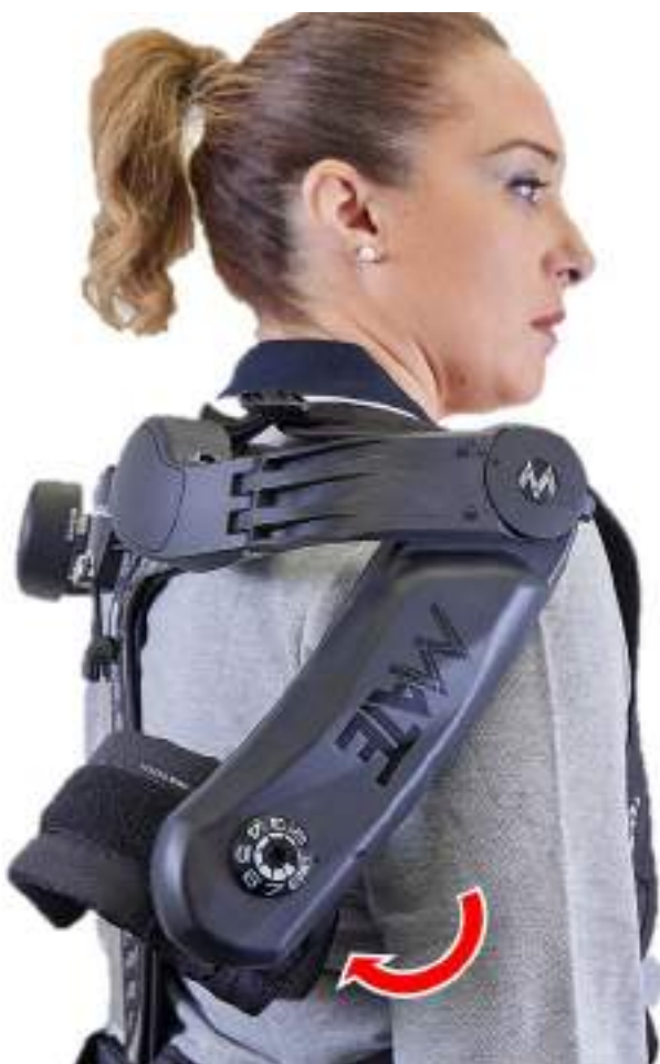
Fig. 3.5 - Torque Generating Box in posizione di riposo posteriore. Questa è l'unica posizione in cui il meccanismo di blocco possa essere attivato o disattivato
