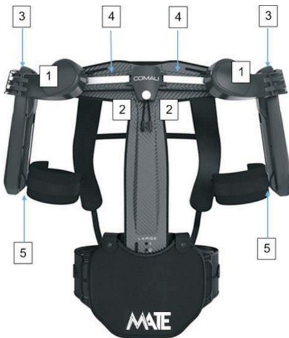
Fig. 3.3 - Gradi di libertà passivi (pDOFs)
