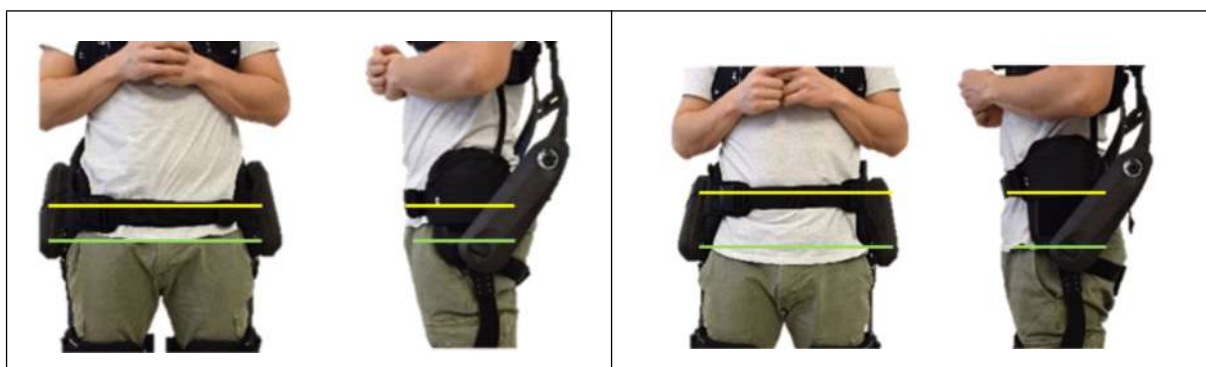
Fig. 4.1 - Hauteur de la ceinture pelvienne
