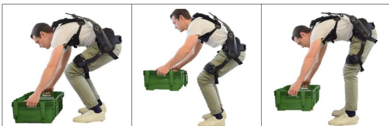
Fig. 2.1 - Exemple de mouvements assistés par le MATE-XB
