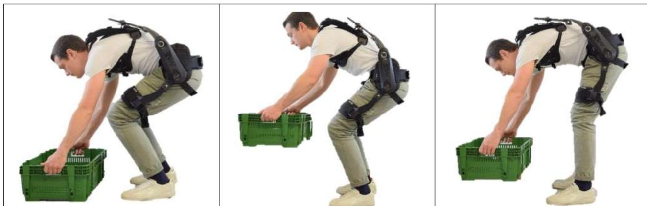
Wenn der Nutzer das Gerät trägt, kann er dessen Unterstützung aktivieren und von den Vorteilen der Assistenz durch das Exoskelett profitieren, während ihm gleichzeitig seine gesamte Bewegungsfreiheit erhalten bleibt. Das Gerät gewährleistet die gleiche Bewegungsfreiheit, wenn die Assistenz nicht aktiv ist.
