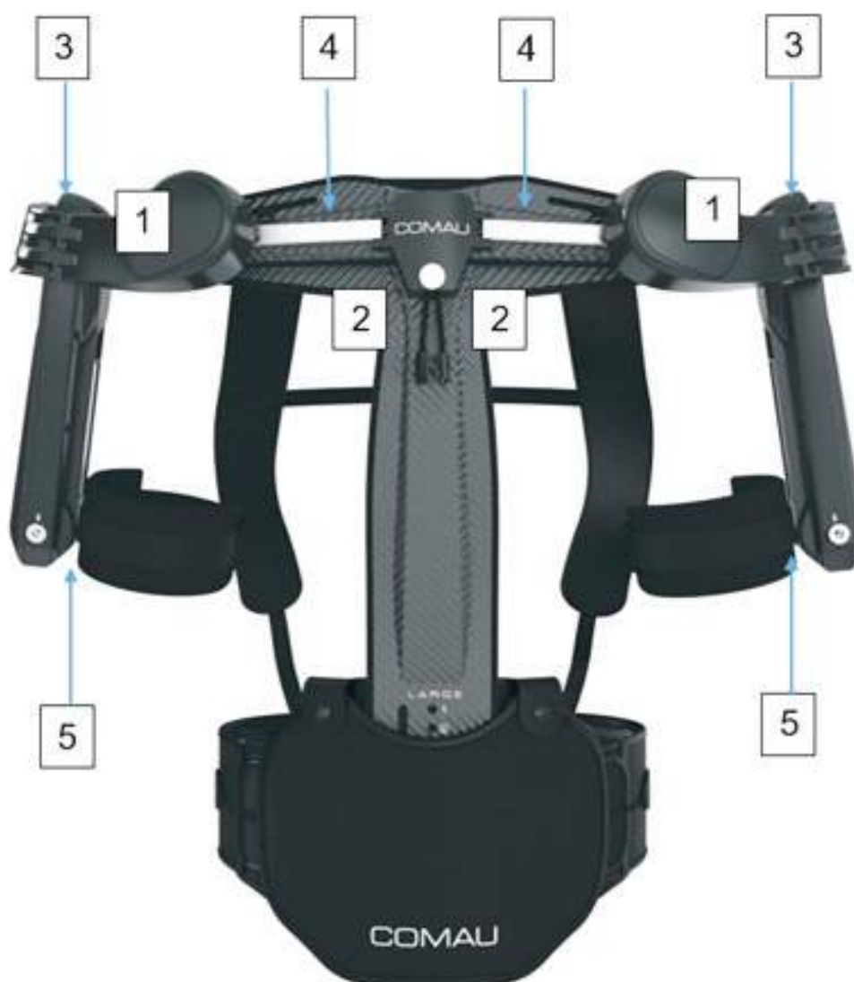
Fig. 3.3 - Gradi di libertà passivi (pDOFs)
