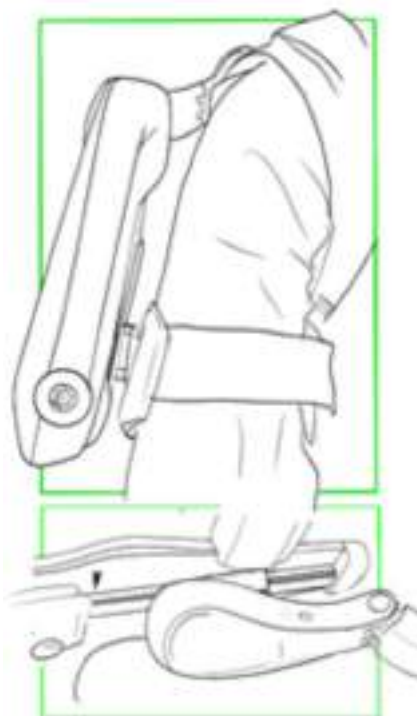
Fig. 6.1 - Dettaglio sulle slitte della TGB e dei pDOFs
