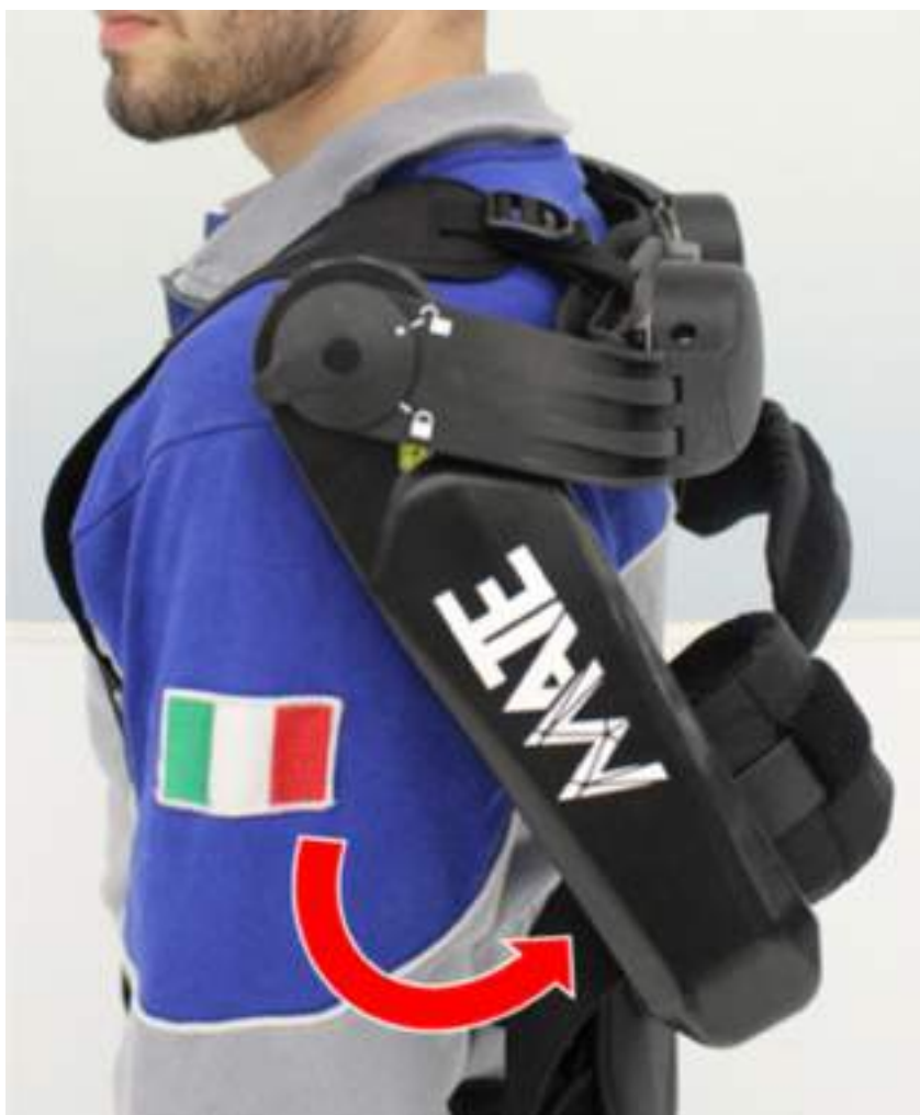
Fig. 3.5 - Torque generator Box in posizione di riposo posteriore. Questa è l'unica posizione in cui il meccanismo di blocco possa essere attivato o disattivato
