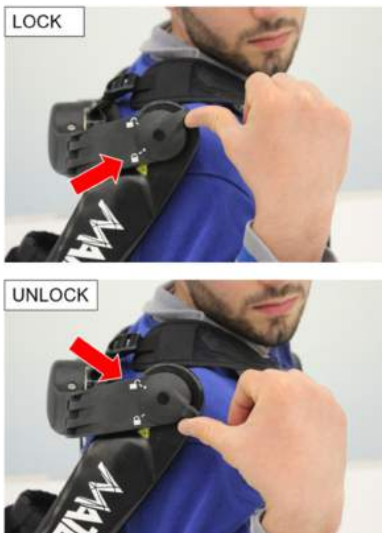
Fig. 3.6 - Torque Generator Box (TGB): meccanismo di blocco
