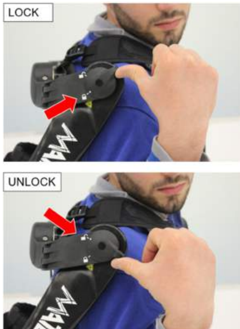
Fig. 3.6 - Torque Generator Box (TGB): Sperrmechanismus
