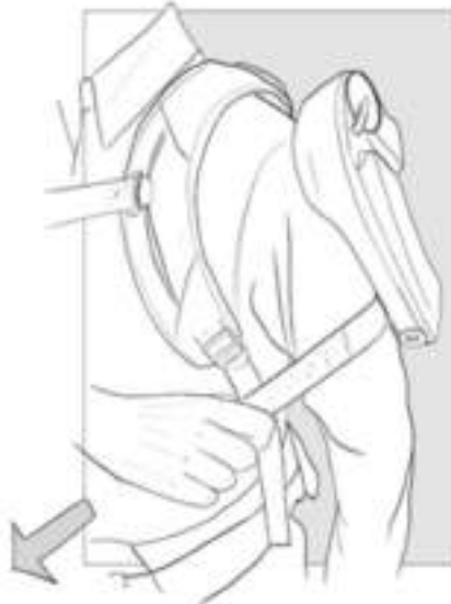
Fig. 5.7 - Verfahren zum Aktivieren der Torque Generator Box
