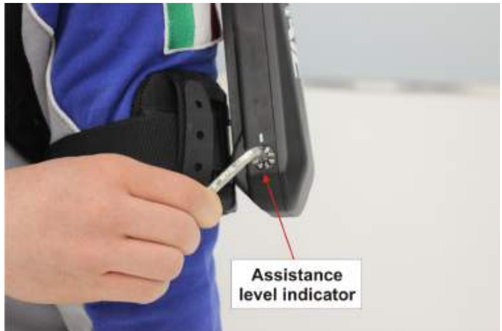
Fig. 4.3 - Detailansicht der Regulierstelle an der Torque Generator Box und Anzeige des Unterstützungsgrads
