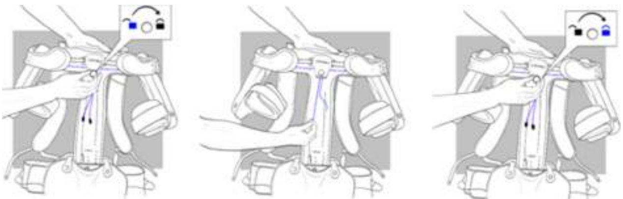
Fig. 4.2 - Einstellung der hinteren Gummibänder
