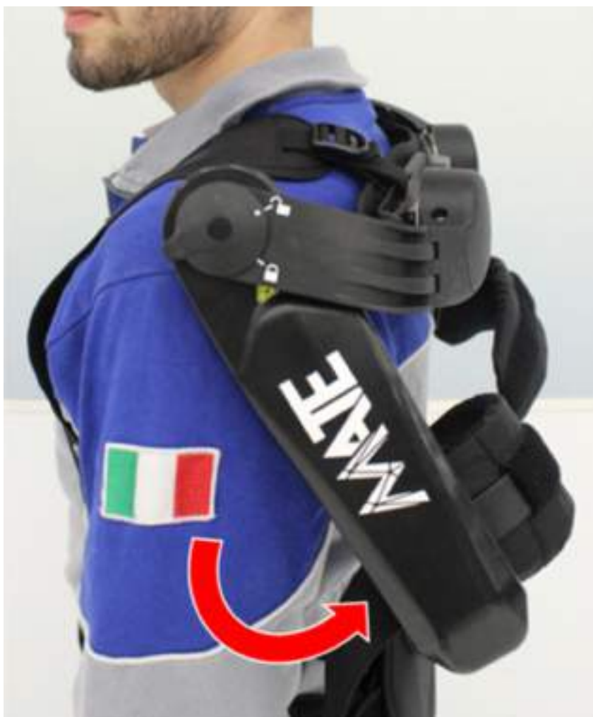
Fig. 3.5 - Boîtier générateur de couple en position de repos arrière. C'est la seule position sur laquelle le mécanisme de blocage peut être activé ou désactivé.
