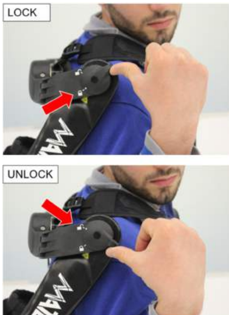
Fig. 3.6 - Boîtier générateur de couple : mécanisme de blocage
