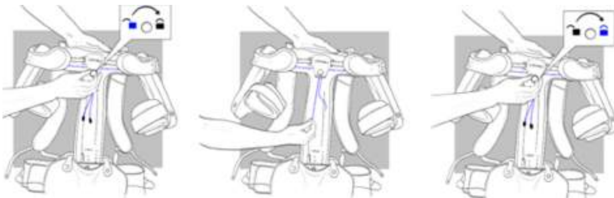
Fig. 4.2 - Modalità di regolazione degli elastici posteriori
