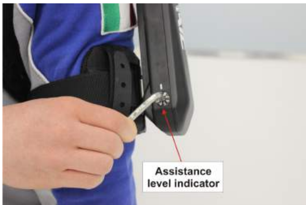
Fig. 4.3 - Vista ravvicinata della sede di regolazione posta sulla Torque Generator Box ed indicatore del livello di assistenza
