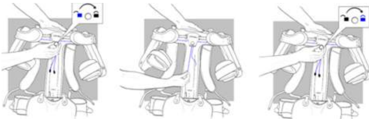
Fig. 4.2 - Modalité de réglage des élastiques arrière
