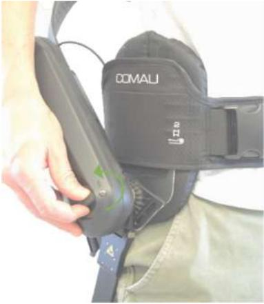
A close-up photograph showing a person's hand turning a black rotary knob on a device. The device has the 'COMAU' logo and a small indicator light. The hand is positioned to turn the knob clockwise. | <ul style="list-style-type: none"><li>- Pour habiliter l'assistance, tourner le bouton rotatif de la valeur 0 à la valeur I, jusqu'à la position signalée par un déclic.</li></ul> |
